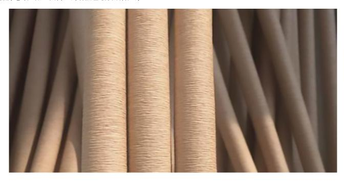
皱纹绝缘纸管是电绝缘用纸的总称。 用作电缆、线圈等各项电器设备的绝缘材料。除都具有良好的绝缘性能和 机械强度外,还各有其特点。
