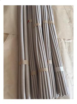
绝缘纸的作用是在电气设备中把电势不同的带电部分隔离开来。因此绝缘纸首先应具有较高的绝缘电阻和耐压强度,并能避免发生漏电、击穿等。其次耐热性能要好,避免因长期过热而老化变质;此外,还应有良好的导热性、耐潮防雷性和较高的机械强度以及工艺加工方便等特点。根据上述要求,常用绝缘纸的性能指标有绝缘强度、抗张强度、比重、膨胀系数等。绝缘耐压强度:绝缘体两端所加的电压越高,材料内电荷受到的电场力就越大,越容易发生电离碰撞,造成绝缘体击穿。使绝缘体击穿的比较低电压叫做这个绝缘体的击穿电压。使1毫米厚的绝缘纸击穿时,需要加上的电压千伏数叫做绝缘纸的绝缘耐压强度,简称绝缘强度。由于绝缘纸都有一定的绝缘强度,各种电气设备,各种安全用具(电工钳、验电笔、绝缘手套、绝缘棒等),各种电工材料,制造厂都规定一定的允许使用电压,称为额定电压。使用时承受的电压不得超过它的额定电压值,以免发生。
