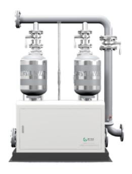
无负压供水设备通过智能控制技术与稳压补偿技术实现设备对市政管网不产生负压,保证向用户管网不间断供水。设备采用的流量控制器在维持比较低服务压力的基础上能够自动调节市政管网向设备的输入水量,确保市政管网不产生负压,用水高峰期时能量储存器释放预充的一定压力的氮气,保证稳压补偿罐高压腔的水带有一定压力补偿到恒压腔中,在一定时间内可补充市政管网来水量的不足,通过双向补偿器,在用水低谷期时对稳压补偿罐进行蓄能,对用户管道起稳压补偿作用,夜间及小流量供水时可通过小型膨胀罐供水,防止水泵频繁启动。充分利用了市政管网的压力,节能效果。
